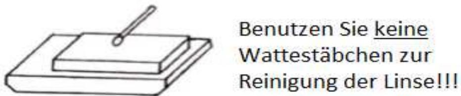
Reinigen Sie den Spiegel mit den dazu gelieferten Tüchern und der Reinigungsflüssigkeit. Achten Sie darauf das Tuch immer nur in eine Richtung zu ziehen.
