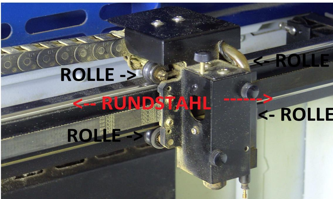
Die Führungsschienen und Rollen des Schneidkopfes durch Abwischen mit dem vorgesehenen Tuch von Schmutz befreien und mit dem leicht eingölten Pflegetuch fetten.
