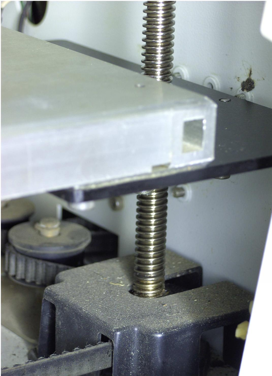
Das Auf- und Abfahren des Arbeitsbereiches erfolgt mit Hilfe eines Spindelhubantriebs mit 4 Spindeln. Nach der Innenraumreinigung können die Spindeln mit Hilfe eines Tuches gereinigt, entfettet und neu abgeschmiert werden. Die Spindeln werden UNTER der Arbeitsfläche angetrieben. Eine Reinigung sollte sowohl den Teil unter als auch über der Arbeitsfläche betreffen. (Manuell auf- und abfahren)
