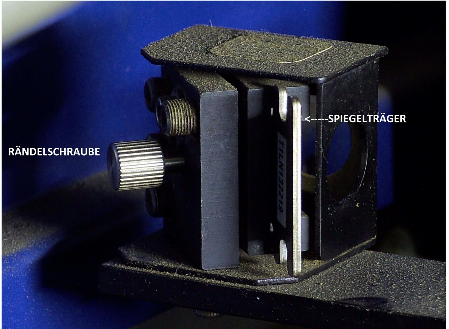
Rändelschraube per Hand entgegen den Uhrzeigersinn lösen. Spiegelträger herausziehen. Spiegel reinigen. In umgekehrter Reihenfolge wieder zusammensetzen.
