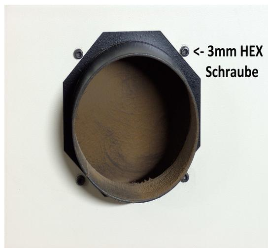
Die Klappe kann nun mit den beiden Kunststoffentriegelungen (nach unten ziehen) geöffnet werden. Das ist notwendig, um die schwere Absaugereinheit festzuhalten, wenn man mit einem 3mm Hexschraubendreher die letzte der 4 Schrauben löst.
