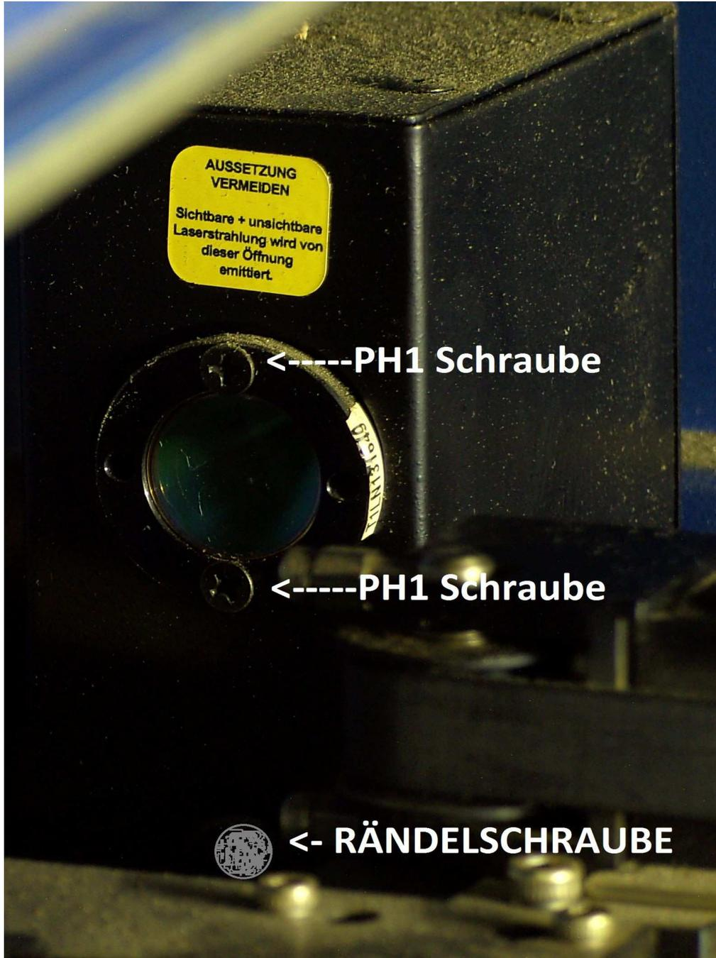
Laserstrahlaustrittsglas durch Herausdrehen der beiden Phillipsschrauben entgegen den Uhrzeigersinn lösen/abnehmen, reinigen und an einem sicherem Platz ablegen. Rändelschraube entgegen den Uhrzeigersinn herausdrehen. Eckspiegelabdeckung nach oben abziehen.
