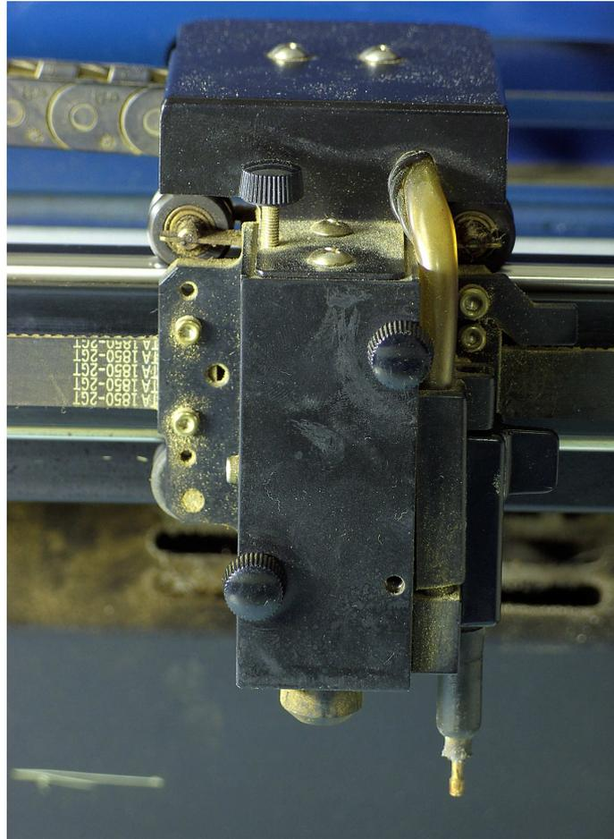
Vordere Rändelschrauben entgegen den Uhrzeigersinn herausdrehen und Deckel abnehmen. Obere Spiegellarretierschraube nur lösen.
