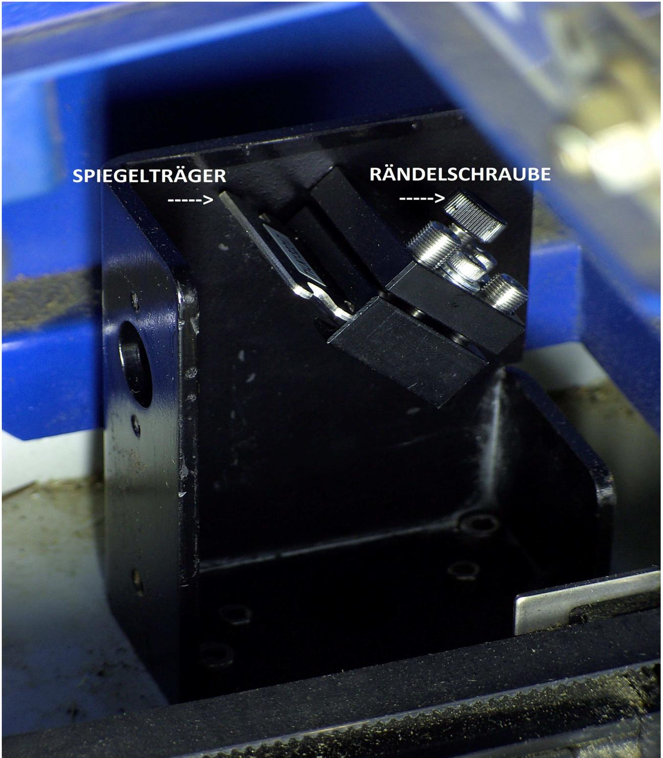
Rändelschraube lösen, Spiegelträger in Fluchrichtung herausziehen.
